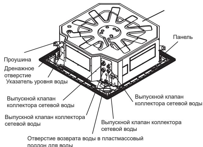
Четырехпоточный кассетный фанкойл (компактный)
