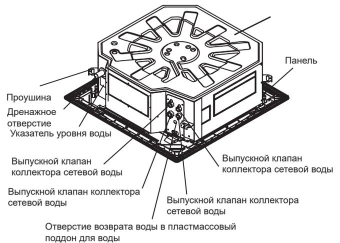
Четырехпоточный кассетный фанкойл (компактный)
