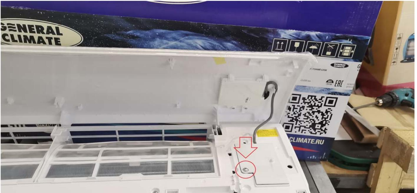
2. Кабель для подключения модуля находится внутри. Что бы его достать необходимо открутить винт крепления кабеля. Удалить крепление и вытащить кабель.
