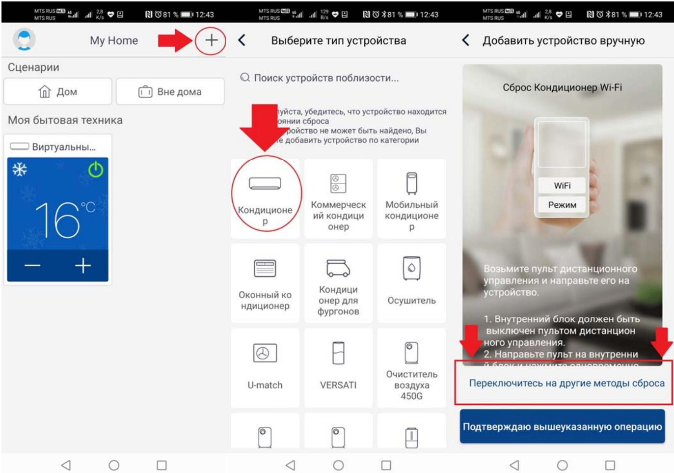
6. В окне выбираем пульт без кнопки WiFi. Жажимаем на пульте кнопки Mode + Turbo (на дисплее отобразится значок WiFi. Если он уже отображается, то для начала необходимо его выключить комбинацией Mode + Turbo). После второго звукового сигнала нажимаем кнопку подтвердить и ожидаем 2 минуты.
