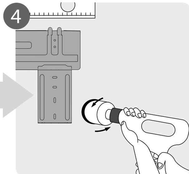
Просверлить отверстие в стене
