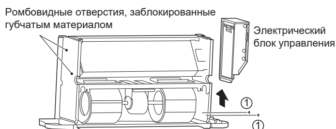
Рисунок 5-19 Снятие электрического блока управления и блокировка ромбовидных отверстий
