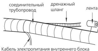
**Примечание:** Кабель электропитания и сигнальный провод (управления) не должны соприкасаться.
